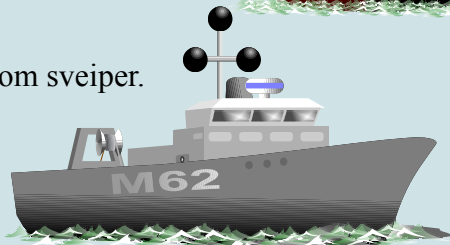
Fartøy som utfører undervannsarbeide , f.eks mudring. Fartøyet passeres på "diamantsiden".
