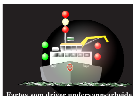
Fartøy som driver undervannsarbeide
