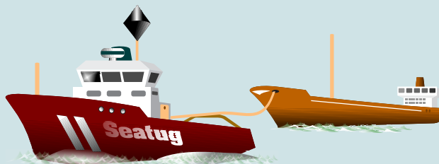
Slepning. Er slepets lengde over 200 m, skal en "diamant" heises på hvert fartøy i sleet.
