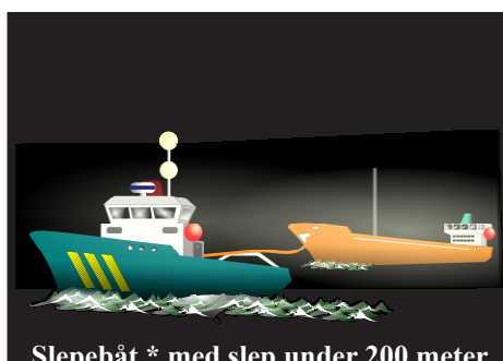
Slepebåt * med slep under 200 meter
